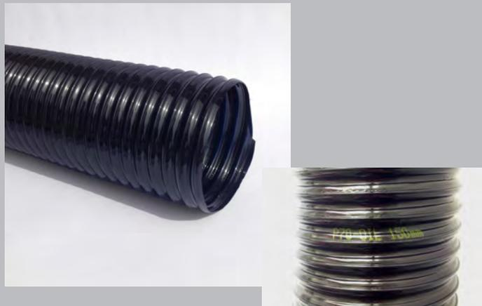
Tubo flessibile realizzato con una foglia (0.45mm) di speciale compound elastico ed autoestinguente, con spirale incorporata in filo di acciaio armonico.
