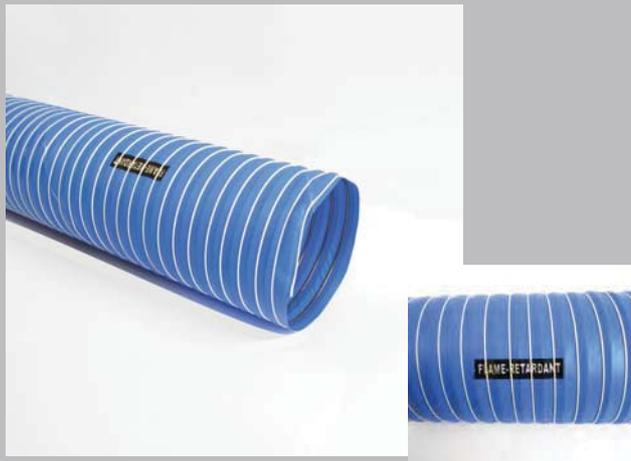
Tubo flessibile realizzato con uno strato di tessuto in fibra di vetro spalmato di silicone **autoestinguente**, spirale interna e visibile in acciaio armonico ramato, cordoncino esterno in fibra di vetro.
