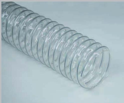
Tubo flessibile realizzato con foglia (sp. 0,45 mm) di poliuretano (Pu) e spirale in filo d'acciaio armonico **zincato**.
