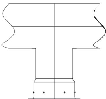
FIG.2 MONTAGGIO SU CANALE CON CANOTTO DI RACCORDO
