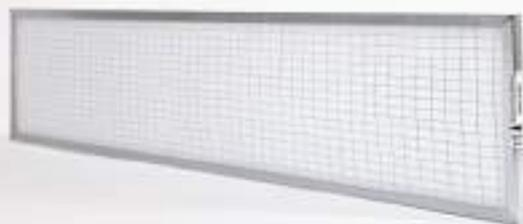
Cella filtrante piana sintetica con telaio sezione ad U in acciaio zincato, doppia rete in filo zincato elettrosaldato che supporta il tessuto filtrante in fibra sintetica di poliestere serie AT150 in fiocco termolegante con grammatura di 150 gr/m<sup>2</sup> e spessore di 14-16 mm.
